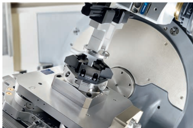
Na veľtrhu AMB spoločnosť SCHUNK predstavila širokú škálu prístupov k automatizovanému nakladaniu do strojov – od jednoduchých základných až po špičkové riešenia. Obrázok štíhlejšieho automatizačného riešenia TANDEM KRP3
