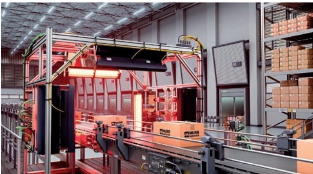
Multiskenovací tunel vybudovaný podľa konceptu Plug-and-Play od spoločnosti Murrelektronik
