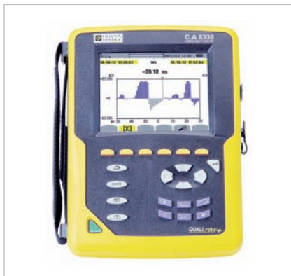
Trojfázový analyzátor kvality elektrickej siete C.A 8336 Qualistar+
